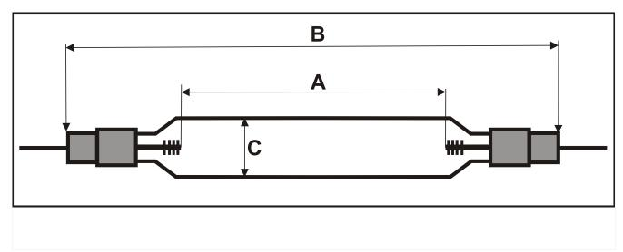
A= Elektrodenabstand Arc Lenght 144 mm Sockel / Base: 44
